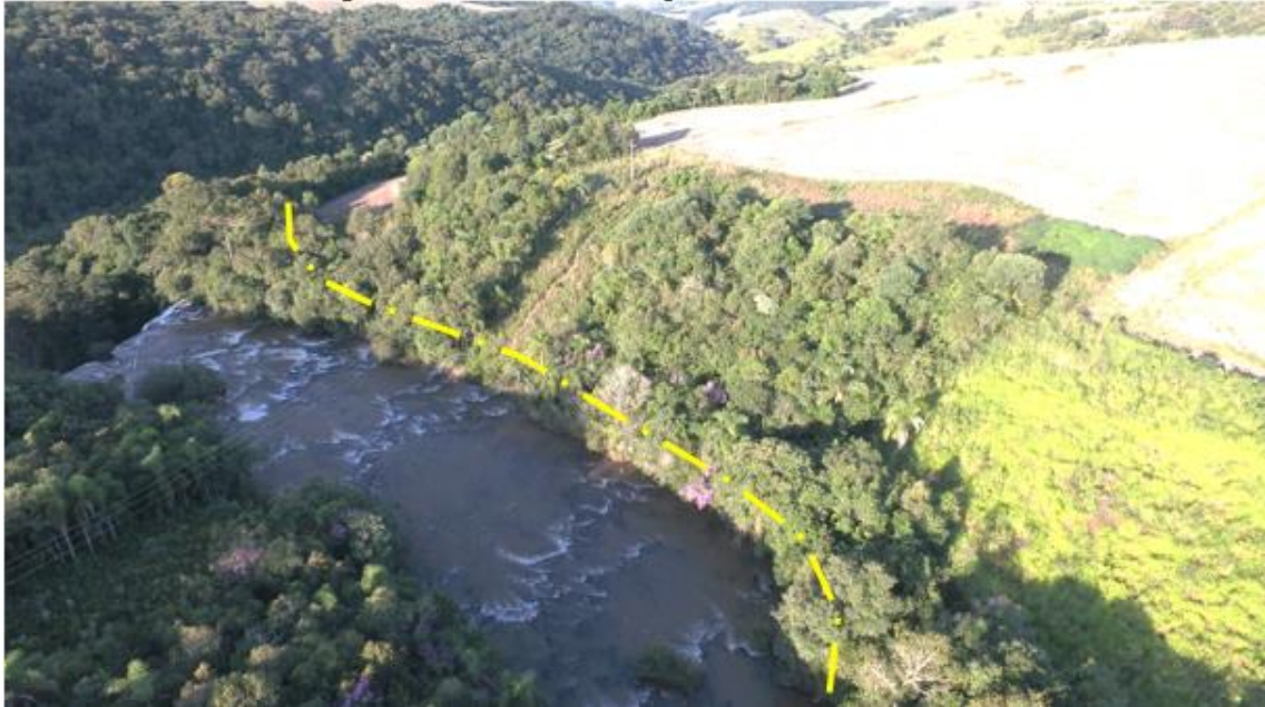
Figura 6 - Traçado do Canal Adutor
