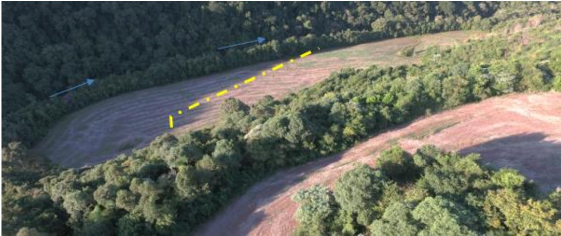
Figura 9 - Traçado do Canal de Fuga
